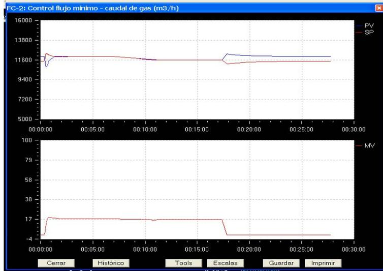
Figura 15. Evolución de la referencia de caudal de aspiración, caudal de aspiración y apertura de la válvula de regulación de flujo de reciclado.
