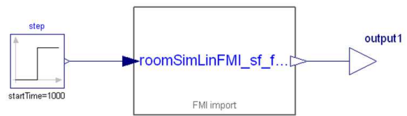
Figura 4: Componente FMU del modelo del sistema de control en Dymola
